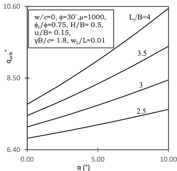
Fig. 11 : Variation of  $q_{urik}^*$  versus  $\alpha$  -Effect of  $L_r/B$
