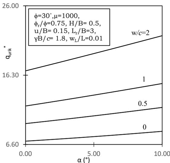
Fig. 14 :  $q_{urik}^*$  versus  $\alpha$  (°)-Effect of  $w/c$
